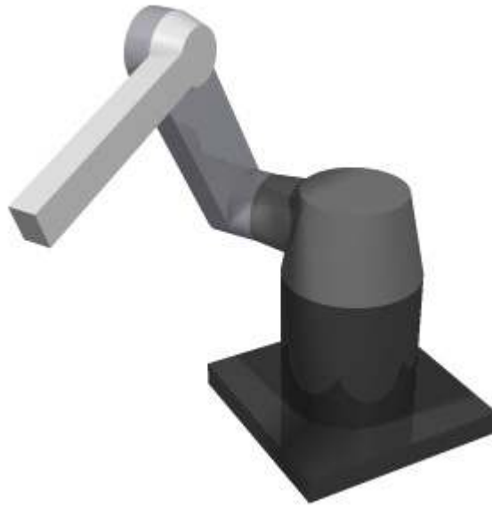
Figura 3.17 – Robô articulado ou revoluto
